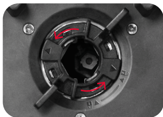
Veio de acionamento removido
