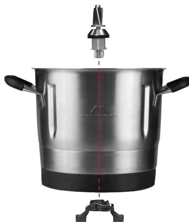
Schema del posizionamento dell'asse motore e vite di bloccaggio della pentola
